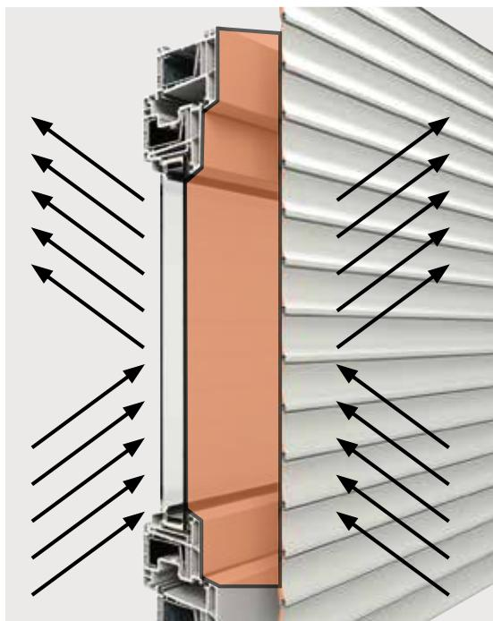
La couche d'air entre la fenêtre et le volet roulant fermé isole et se comporte comme un élément calorifuge. Vous faites des économies d'énergie.
